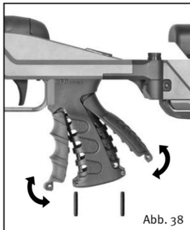
Zum Austausch der vorderen oder hinteren Griffenlage den Haltestift herausdrücken und die Griffenlage herausheben.
