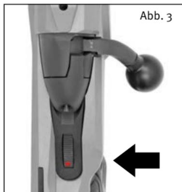
Die Sicherung kann nur betätigt werden, wenn die Waffe gespannt oder der Kammergriff geöffnet ist! Die „2 + 1 Stellungen Sicherung“ von STEYR ARMS
