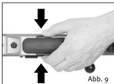
Mit dem Daumen und Zeigefinger einer Hand die beiden Drücker links und rechts am Magazin bis auf Anschlag gegeneinander drücken und gleichzeitig das Magazin herausziehen.
