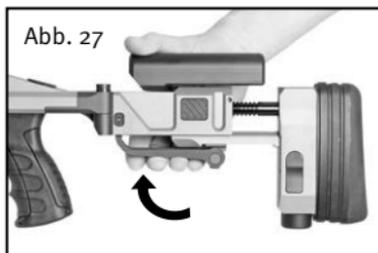
5. Schwenken Sie den Klemmhebel in die oberste Position bis dieser in der Sicherung, Klemmhebel einrastet.
