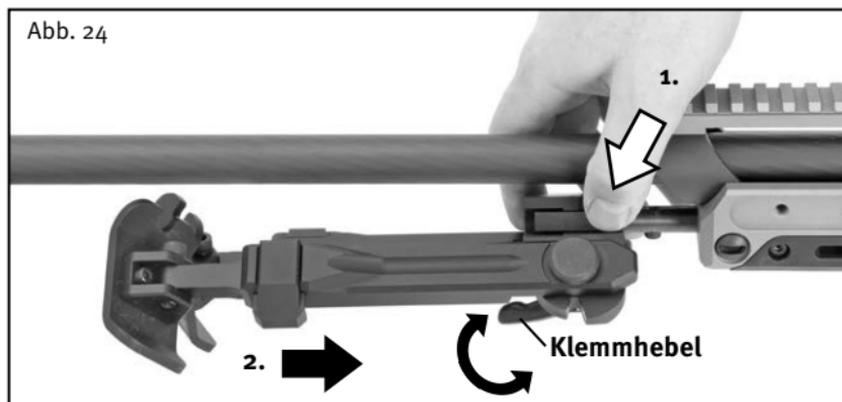
1. Lockern Sie den Klemmhebel durch Drehen im Uhrzeigersinn (aus der Schießposition gesehen).
