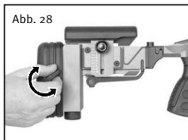
1. Lockern Sie Klemmschraube vollständig.
