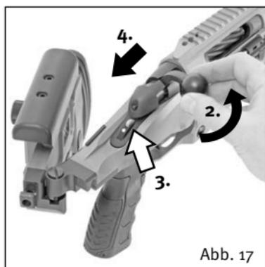
2. Drehen Sie den Kammergriff mit der rechten Hand um  $70^\circ$  nach links (entriegeln).
