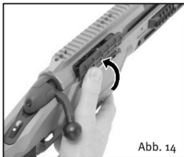
5. Schwenken Sie den Staubschutzdeckel mit dem rechten Daumen bis zum Einrasten nach oben.
