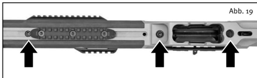
Das vollständige Zerlegen der Waffe durch den Anwender ist weder üblich noch erforderlich. Die drei Schrauben an der Waffenunterseite verbinden das System und die Stützhülse mit dem Vorderschaft.
