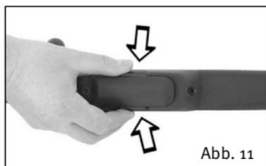
Mit dem Daumen und Zeigefinger einer Hand die beiden Drücker links und rechts am Magazin bis auf Anschlag gegeneinander drücken und gleichzeitig das Magazin herausziehen.
