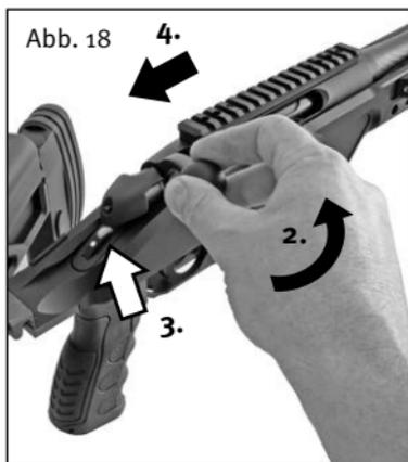
2. Kammergriff mit der rechten Hand um 70° nach links drehen (entriegeln).
