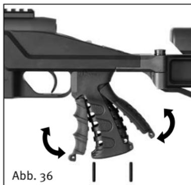
Zum Austausch der vorderen oder hinteren Griffenlage den Haltestift herausdrücken und die Griffenlage herausheben.
