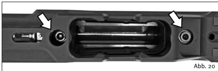
Werden diese Schrauben gelöst, müssen sie mit einem Drehmomentschlüssel (7 Nm) festgezogen werden.
