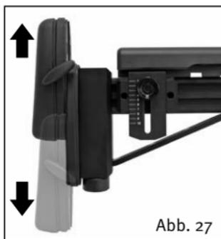
Die Schaftkappe kann in der Höhe an den Schützen angepasst werden. Klemmschraube lösen, Schaftkappe in die gewünschte Position schieben, Klemmschraube festschrauben.
